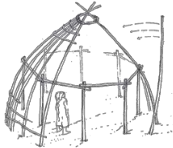
Δομικός σκελετός κατασκευής grass house Wichita. [4]
