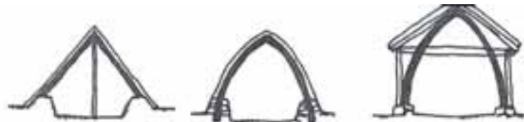
Εξέλιξη του δομικού σκελετού Cruck. [4]
