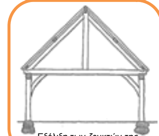
Εξέλιξη των ζευκτών της κατασκευής Cruck.
