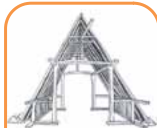
Πρώιμος σκελετός κατασκευής με εγκοπές.
